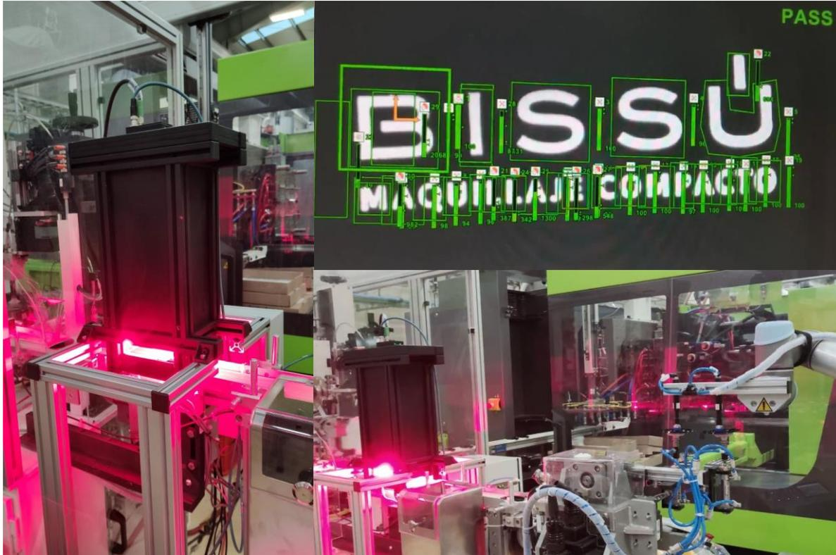
Terzett Technologix creó un juego de lámparas y un sistema de iluminación específico para materiales ultra reflejantes empleados en la industria de los cosméticos.
